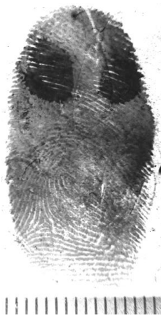
Иллюстрация 5. След пальца руки наиб. раз-ми 14x27 мм, отко- пированный на тд/пленку раз-ми 34x45 мм
