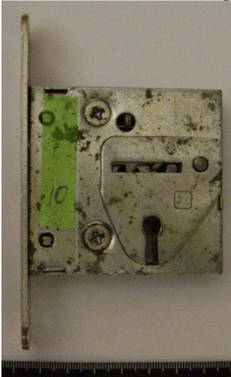
Изображение №1. Общий вид врезного замка с сувальдным механизмом, поступившего на исследование
