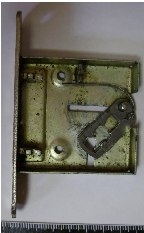
Изображение № 9. Общий вид четвертой сувальды
