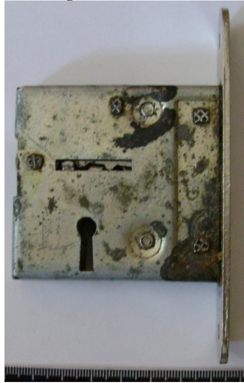
Изображение № 2. Общий вид врезного замка с сувальдным механизмом, поступившего на исследование
